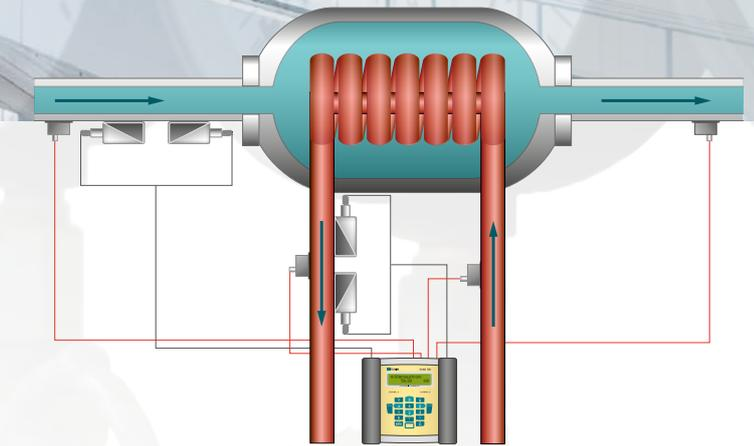
Mesure simultanée de la quantité de chaleur sur les deux circuits d'un échangeur de chaleur (2 mesures de débit, 4 entrées température)
