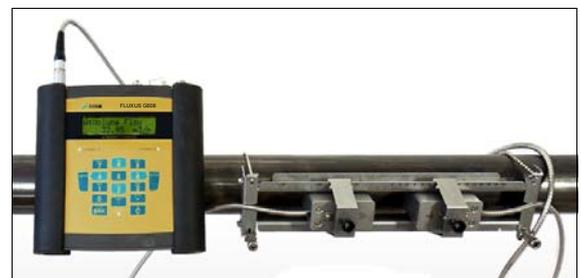
Mesure avec le transmetteur de débit fixé sur la conduite avec le kit de fixation QuickFix
