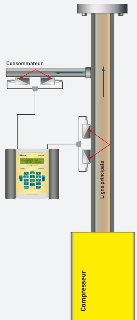
FLUXUS® G601 CA Énergie n'est pas seulement capable de mesurer le débit des liquides, mais aussi la quantité d'énergie thermique et les débits de gaz industriels. Ainsi, le FLUXUS® G601 CA Énergie a été spécialement conçu pour la mesure non-intrusive de débit d'air comprimé.
