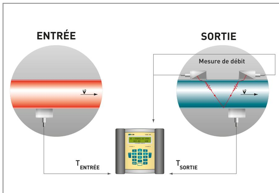
FLUXUS® F601 Énergie mesure l'énergie thermique consommée par un process par détermination des flux de chaleur ou de froid entrants et sortants (méthode de différence). Pour ce faire, les mesures de température dans les conduits d'alimentation et de retour ainsi que la mesure du débit volumique dans le process sont nécessaires. FLUXUS® utilise les valeurs mesurées pour le calcul du débit de l'énergie thermique sur la base des courbes d'enthalpie du fluide stockées dans la mémoire interne.
