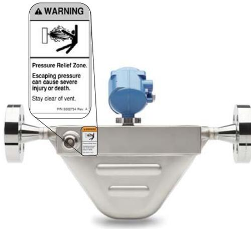
Le capteur doit être orienté de manière à ce que le personnel et l'équipement ne soient pas exposés en cas d'échappement le long de la trajectoire de décharge de pression. Tenez-vous à distance de la zone de décharge de pression du disque de rupture. L'échappement d'un fluide à haute pression du capteur peut entraîner des blessures graves, voire mortelles.
